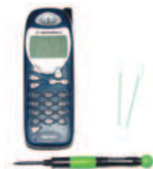
Чтобы залезть в мобилник, тебе нужна специальная отвертка, спирт, ушные палочки с ваткой.
